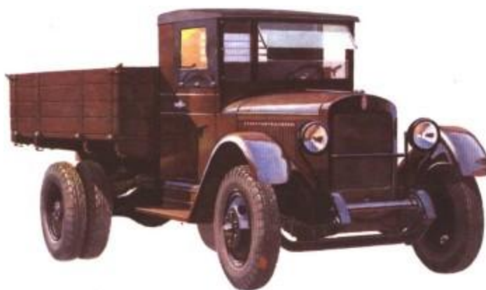
Рисунок 4. АМО-2, собранный из узлов «AutoCar-SA»
